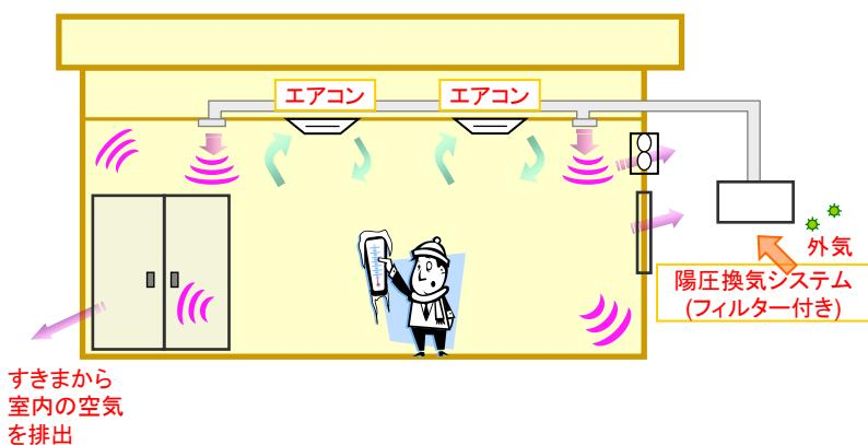
すきまから塵埃の侵入をシャットアウトするには、フィルタなどで浄化した空気を取り入れ、室内を陽圧(正圧)に保つ必要があります。しかし調温湿されない外気を取り込むと冷暖房が効かなくなります。
