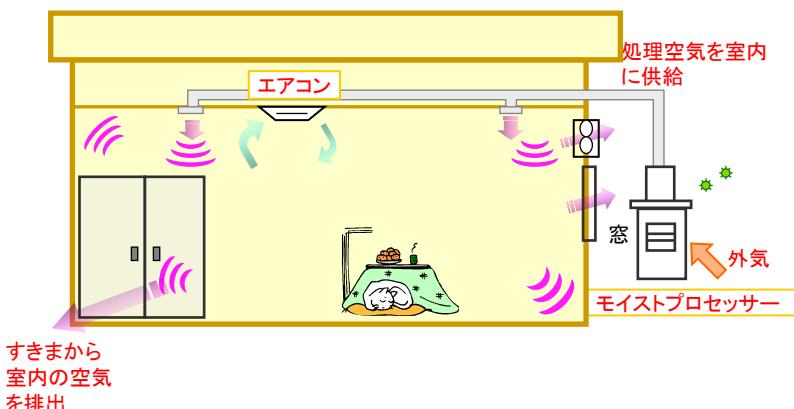
弊社のモイストプロセッサーは温湿度を調節し、除塵の上外気を室内に供給します。
