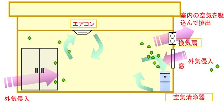
現在の一般的な換気方式では、外気を室内に取り入れるため換気扇を動かすことでの、ドア、窓の隙間から外気が侵入してしまいます。これでは、室内に空気清浄機を設置しても効果がありません。
